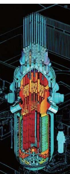
伊方原発3号機原子炉格納容器には157体の燃料集合体が一時に収納することができます。このうち、MOX燃料集合体は、16体。経産省からの設置許可では40体以下となっているが、現在は16体しか収納していない。残り141体は通常のウラン燃料集合体。(いきなり、40体ではリスクが高いという判断だと考えられる。なお、同原子炉はもともとウラン燃料用に設計されているが、MOXペレットの溶融点はウラン燃料よりも70度も低い摂氏約2720度などウラン燃料に比べてリスクが大きくなる。)
