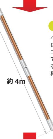
ペレット約360個が細長く燃料棒に格納されている。燃料棒はジルコニア合金で被覆されている。従って5gのペレットが360個入っているので、ペレット自体の重量は燃料棒1本あたり約1800gになる。
