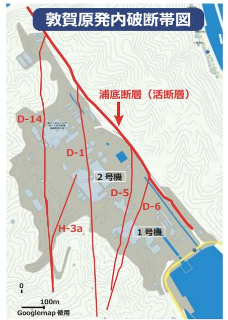
【参照資料】原子力規制委員会敦賀原子力発電所内破砕帯に関する有識者会合 平成25年5月15日資料「日本原子力発電株式会社敦賀発電所の敷地内破砕帯の評価について(案)」P17よりトレース作成
