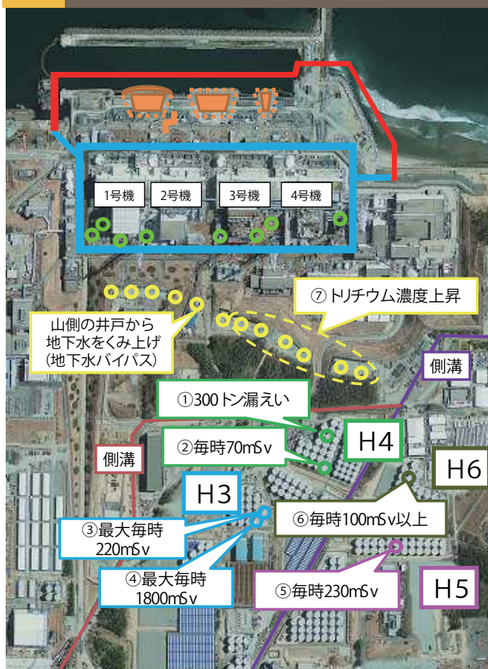
図7 タンクからの汚染水漏洩の現状
