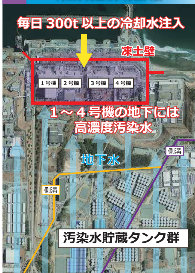
図 1 汚染水発生メカニズム
