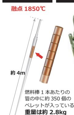
図C 沸騰水型原子炉用 燃料集合体
