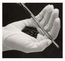
左の写真はウラン燃料棒とペレット。 燃料被覆管(ねんりょうひふくかん、 Fuel tube)はジルコニウム合金で出来 た、厚さ2mm、直径1cm強で、長さが 約4mのきわめて細長い形状の管である。
