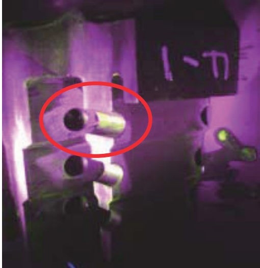
羽根フォーク部のひびの例
