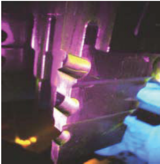
羽根フォーク部のひびの例
