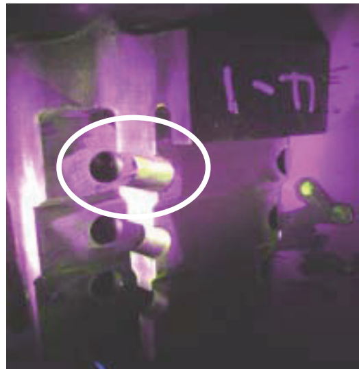
羽根フォーク部のひびの例
