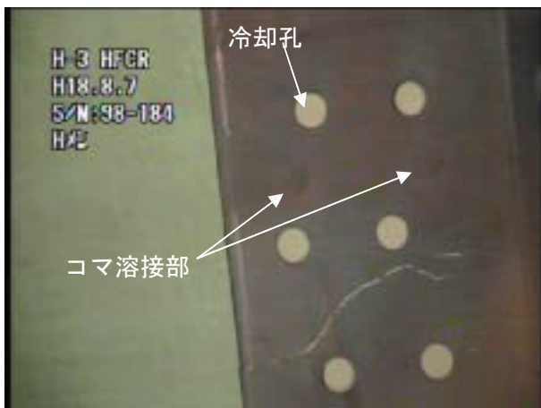
ハフニウム板型制御棒のひび割れの例
