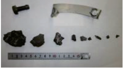
<過給機付近にて発見された金属片>
